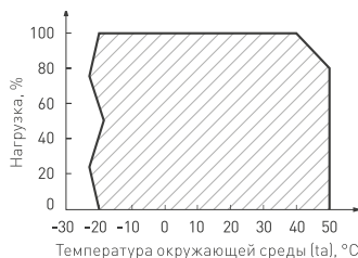
Рис. 3. Максимальная допустимая нагрузка, % от мощности источника
